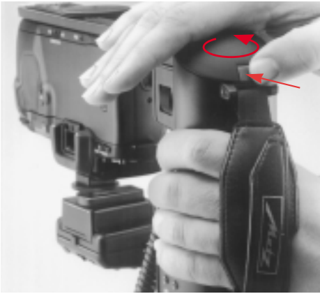
Bild 3: Entriegeln und Einsetzen des Akkus
